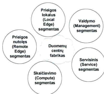
pav. 7-7 Duomenų centro fabriko segmentų loginė schema
